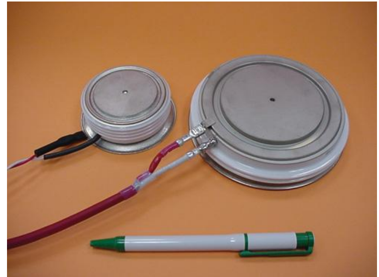
SCR: Levo: 4,5kV; 1,5kA Desno 8,5kV; 6,6kA
