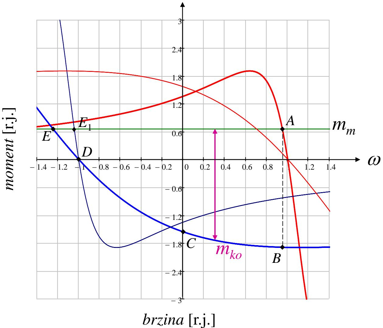
U bilo kom trenutku u periodu rada između tački (C) i (D) može se isključiti (premostiti, kratko spojiti) dodati otpor, čime se povećava moment motora, a time i koeficijent ubrzanja. Ustaljeno stanje koje se tada dobija je na manjoj brzini, tačka (E<sub>1</sub>).
