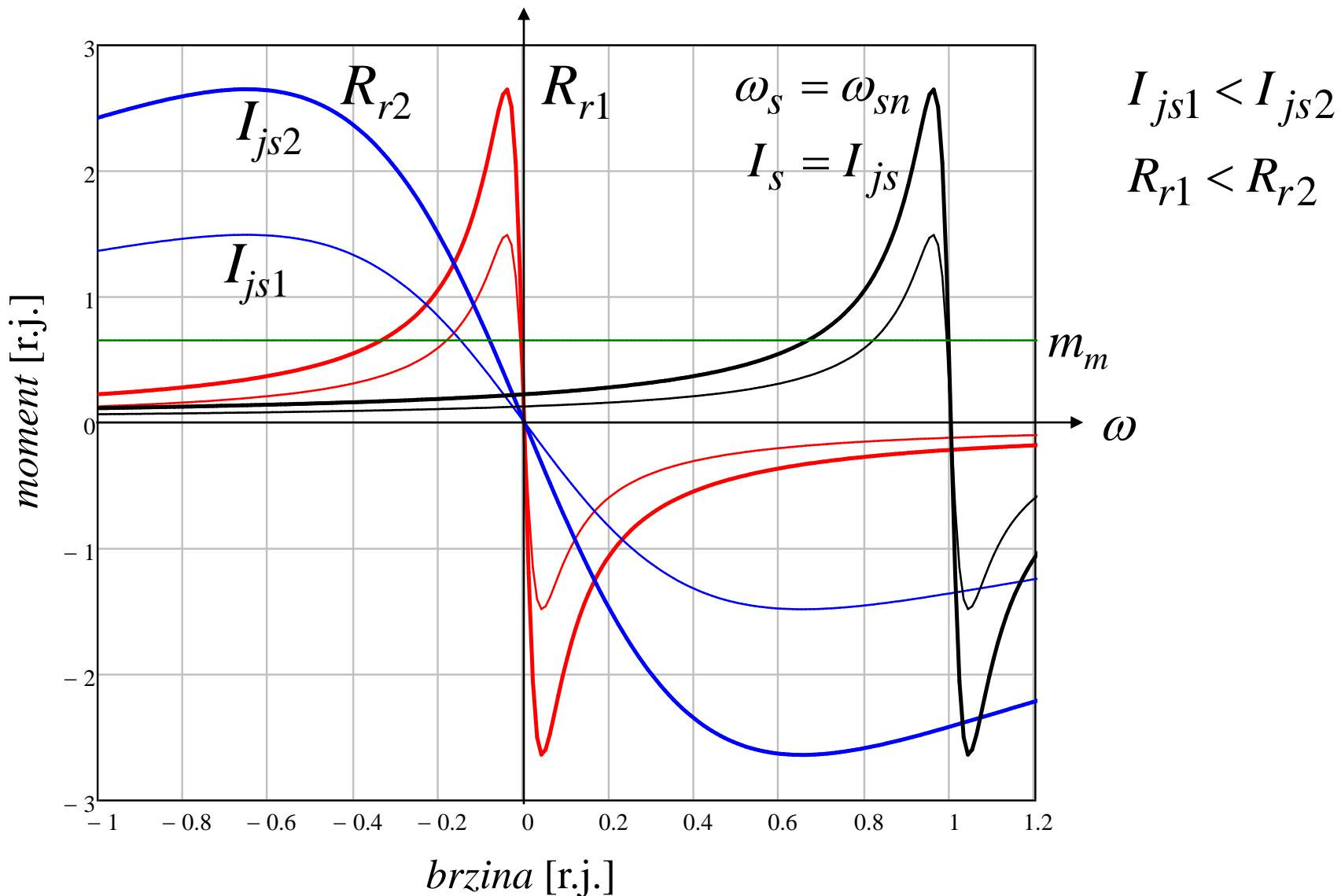
Pogodne mehaničke karakteristike mogu se ostvariti podešavanjem vrednosti jednosmernog napona, odnosno struje i odgovarajućim dodatim otporom rotora (ako je motor sa namotanim rotorom).
