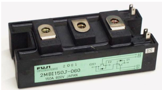
IGBT tranzistor 150A/600V(danas najčešće korišćen poluprovodnički prekidač snage)
