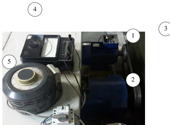
1- Asinhroni motor, 2 – jednosmerni motor, 3 – Kaiš i kaišnici, 4 - Ampermetar u kolu indukta jednosmernog motora, 5 – Autotransformator za podešavanje napona pobude jednosmernog motora
